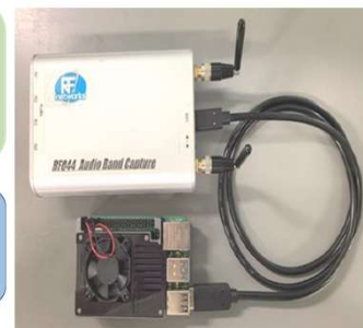
音取得と異常検知システム
